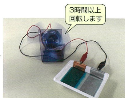
③2種類の試薬が接すると起電します
